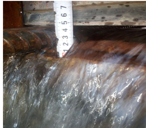
包家沟闸门抬升高度
