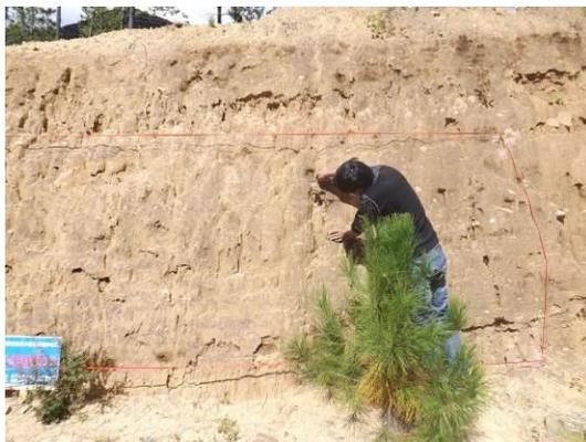
图 1-15 13#监测点坡面侵蚀沟量测（2016 年 9 月）
