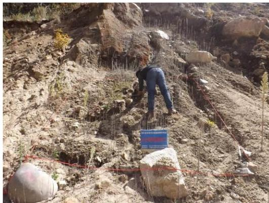
图 1-11 7#监测点坡面侵蚀沟侵蚀测量（2016 年 9 月）
