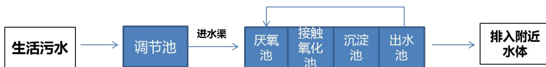
图 4.5-1 生物接触氧化工艺流程示意图
