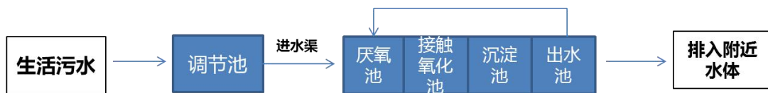
图 4.4- 2 生物接触氧化工艺流程示意图
