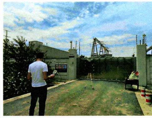
图 4-2 红砂 220kV 变电站东南侧电磁检测
